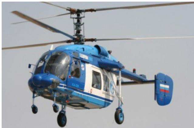
Легкий многоцелевой вертолет Ка-226 с двумя газотурбинными двигателями Allison250-C20R/2 «Роллс-Ройс» и максимальной взлетной массой 3,4 тонны предназначен для перевозки пассажиров (до 7 человек), транспортировки грузов внутри транспортной кабины (до 1046кг), патрулирования экономических зон, мониторинга и решения других специальных задач.
